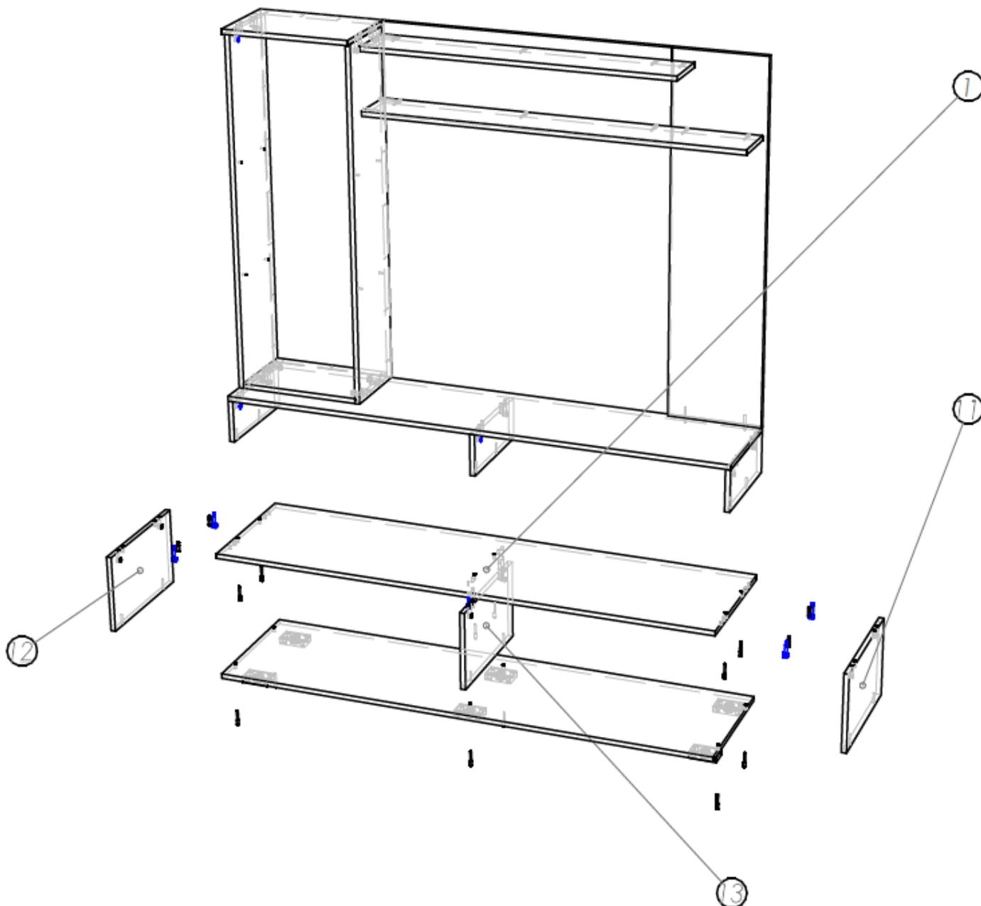
17. На дно тумбы 2 прикручиваем опоры 20мм.
