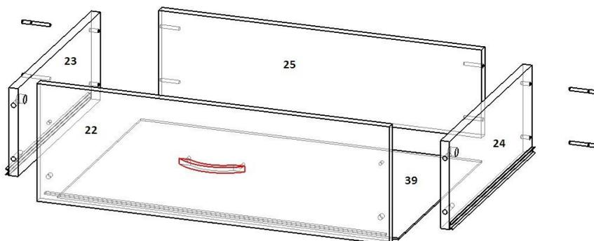
5.2. С помощью эксцентриковой стяжки и шкантов соединяем ПСЯ 22 с БСЯ 23,24. К БСЯ 23,24 евровинтами прикручиваем ЗСЯ 25. На получившуюся конструкцию гвоздями набиваем ДВП 39, предварительно убедившись в равенстве диагоналей. Прикручиваем направляющие ползки 400 мм на БСЯ 23,24 шурупами 3,5x16 (направляющие полного выдвижения крепятся на БСЯ по краю ЛДСП без учета ДВП). Шариковая направляющая шириной — 35 мм.
