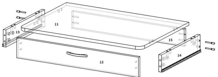
(направляющие полного выдвижения крепятся на БСЯ по краю ЛДСП). Для данного ящика предусмотрена шариковая направляющая шириной — 45 мм.
