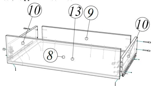
одна отверстием под эксцентриковую стяжку наружу, а другая внутрь выдвижного ящика.
