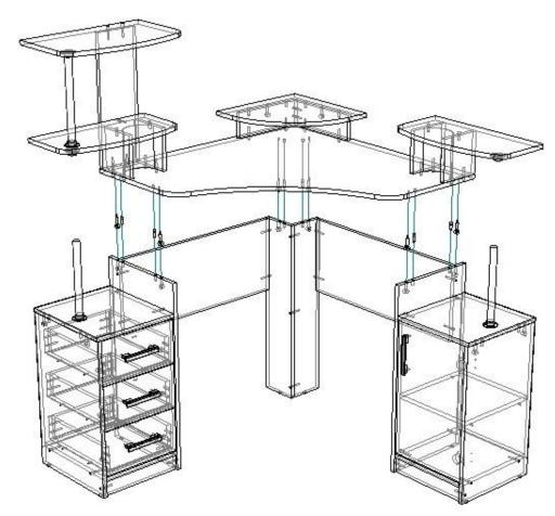
1.12. С нижней стороны столешницы 1 вбить шканты и вкрутить штоки эксцентриковой стяжки. После этого столешницу 1 вместе с надстройкой крепим к бокам стола 4 и 5 на шканты и фиксируем ее эксцентриковой стяжкой, не забывая закрепить тубы с фланцами между крышами 11 и 12 и крышами 23 и 25 шурупами 3,5\*16.
