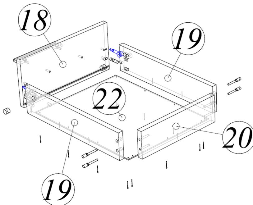
**1.2.** С помощью эксцентриковой стяжки и шкантов соединяем ПСЯ 18 с БСЯ 19.
